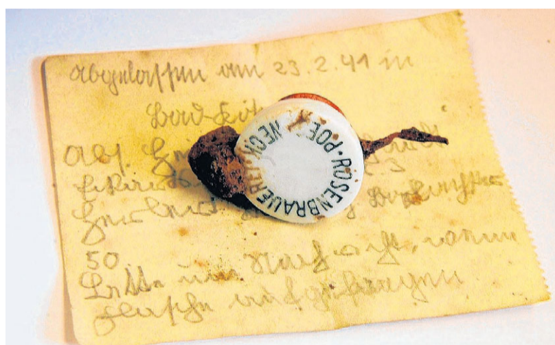
Der Keramikverschluss der Bierflasche hat den jahrzehntelangen Härtetest in der Saale bestanden. Der Eisenbügel ist restlos weggerostet.
